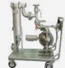
Skid de filtración
